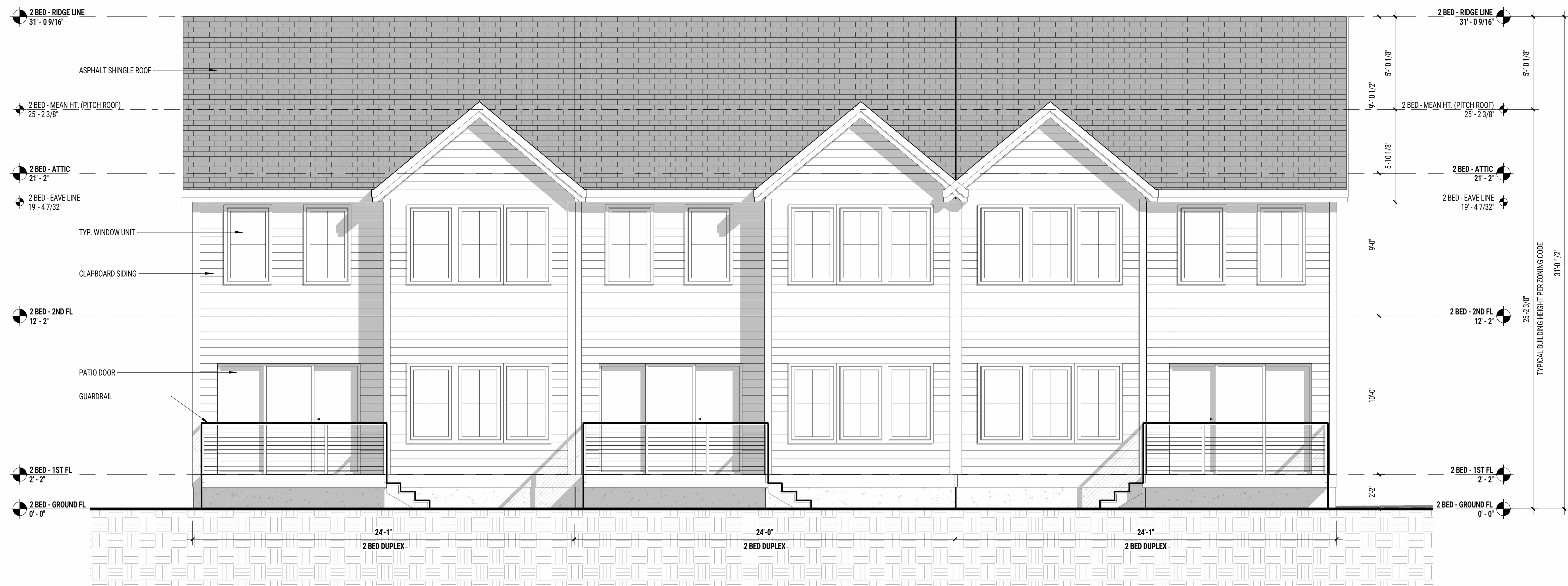
1 2 BED DUPLEX - REAR ELEVATION SCALE: 1/4" = 1'-0"
